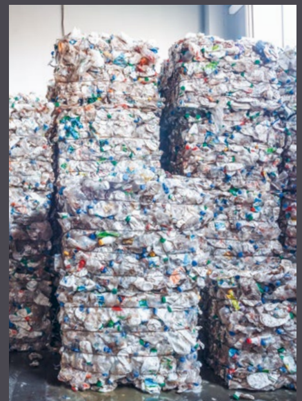
Die sortierten Verpackungen kommen in Ballen an. Um hanit zu erzeugen, kommen in unserem Verfahren auch gemischte Kunststoffe zum Einsatz, die in konventionellen Recycling-Verfahren nicht verwertet werden.
